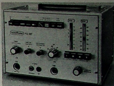
Bild 1. Die übersichtlich gegliederte Frontplatte des Farbbalkengenerators „FG 387“
