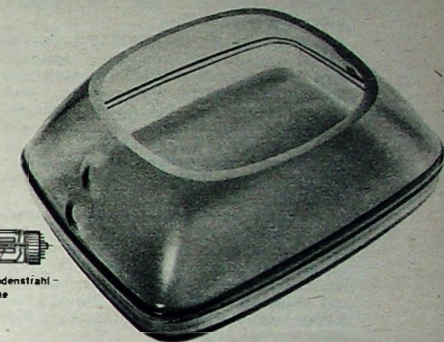
Aufbau der neuen Farbbildröhre von CFT; im obigen Foto ist im Innern des Glaskolbens das die bei Schattenmaskenröhren übliche Lochmaske ersetzende Drahtgitter zu erkennen
